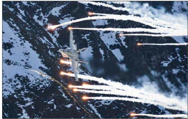
Abb. 6 Einsatz von Flares zum Selbstschutz (LW)
